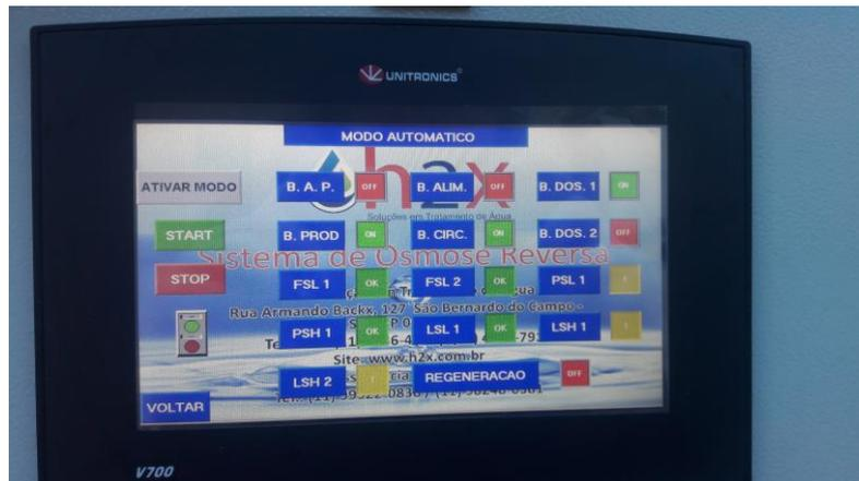
Desenvolvemos programas de automação para todos os processos presentes nas estações de tratamento, como bombeamento, sistemas de aeração, controle de nível de tanques, controle de vazões, pressões, programações de retrolavagens e regenerações entre outros, utilizando inclusive tecnologia própria.
