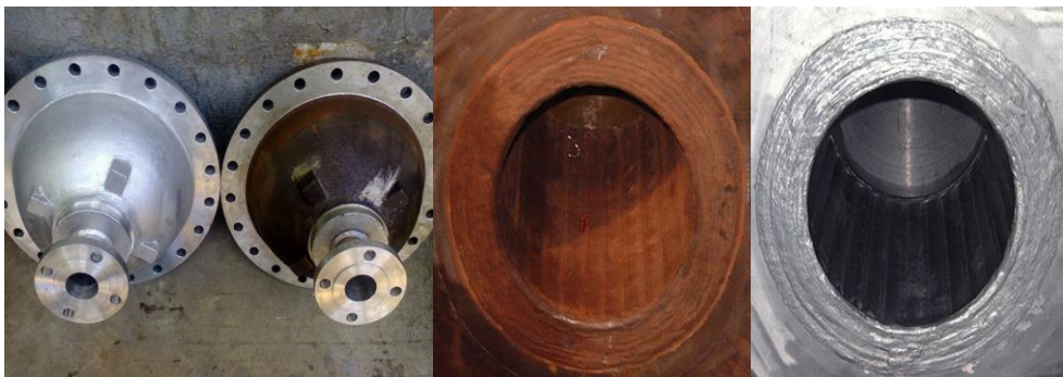
Limpeza Química Localizada
